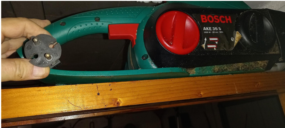
Appareil plastique double isolation - prise sans terre
